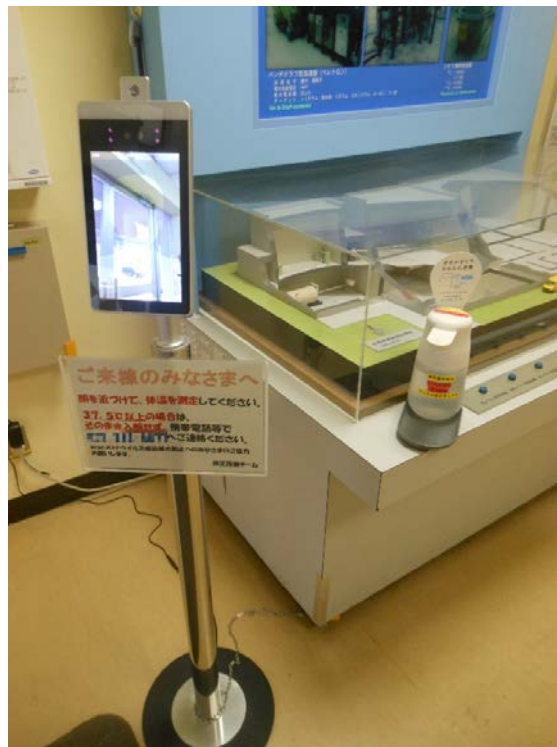
図 2.8.3-4 棟内入口に設置した非接触体温計
